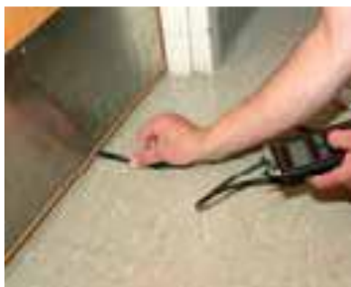
شکل ۷: مرحله ۴ قرار دادن لوله در زیر درب بسته برای اندازه گیری فشار نسبی بین ۲ فضا
