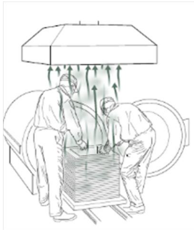
۲- کنترل نامناسب آلاینده ها در منبع انتشار داغ، کارگران در مسیر حرکت توده آلودگی هستند.
