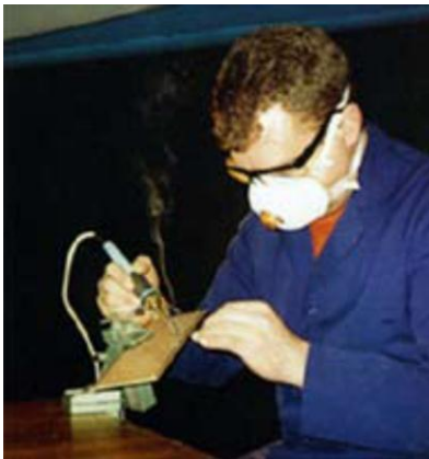
انتشار آلودگی در حین لحیم کاری در شرایط روشنایی معمولی
