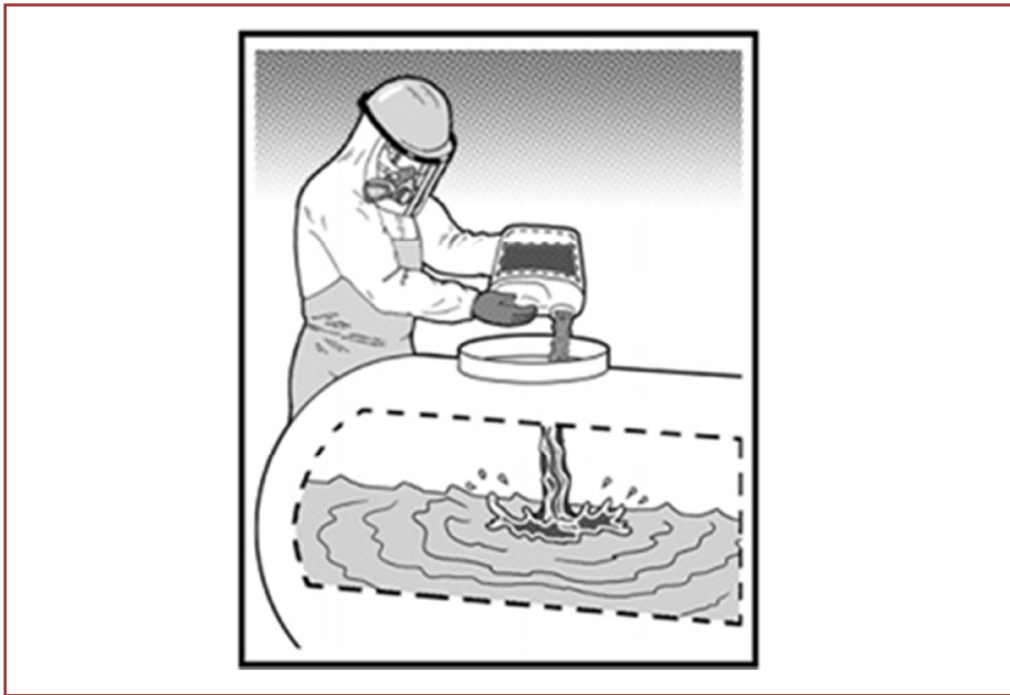
شکل ۲۴- هنگام مخلوط کردن و پر کردن نیاز به بیشترین تجهیزات حفاظت فردی است.
