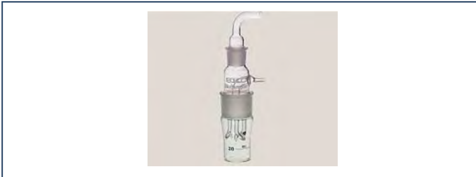
شکل ۵- بیوسمپلر مورد استفاده برای نمونه برداری بیوآئروسول (حاوی سه جت ایجاد کننده برخورد در سطح مایع)
