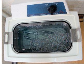
شکل ۹-۳: شستشوی وسایل با اولتراسونیک
