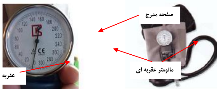
شکل ۷: دستگاه فشارسنج عقربه ای (aneroid monitor)
