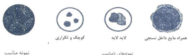
شکل ۲: تصویر نمونه‌های مناسب و نامناسب بر روی کاغذ فیلتر
