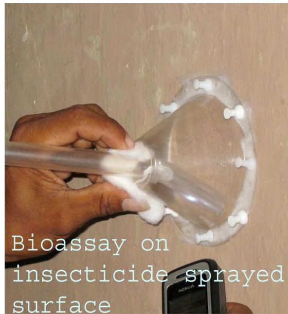
نصب کونیکال بر روی دیوار جهت بررسی خاصیت ابقایی حشره کش
